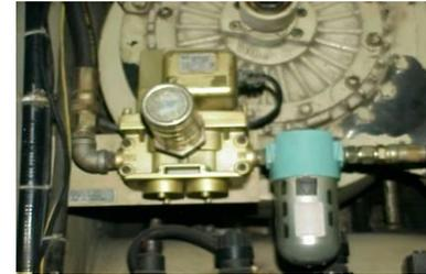
受**PLC**的驅動,雙聯電磁閥控制氣源進入離合器內
