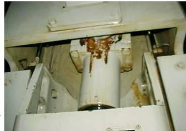
曲軸受內部齒輪的帶動,通過連杆帶動滑塊做上下動作。
